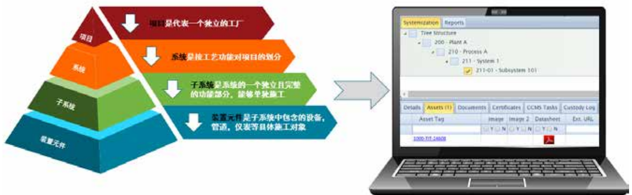
图 1 项目完工试车管理结构
